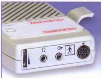
Bedienfeld mit Lautstärke-Regler und Signalausgängen
